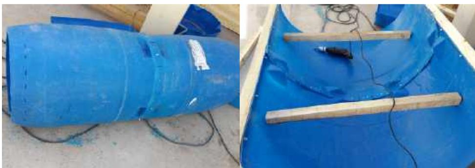
Luego de unir los tambores, colocar los listones de maderas en los dos extremos que estarán en contacto con el suelo. Se recomienda usar prensas para fijarlos y unirlos con tornillos auto perforantes para techo. Se pueden colocar dos palos en el interior para tensar y darle la forma final al tambor.
