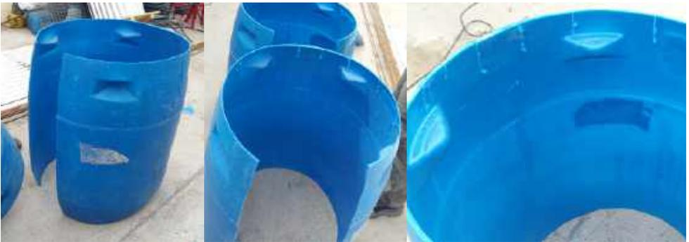
Cortar una lámina de 20 cm de ancho por el largo del tambor. Esto permitirá una apertura del tambor de hasta 73 cm de ancho sobre el piso y una altura interna de 75 cm aproximadamente.
