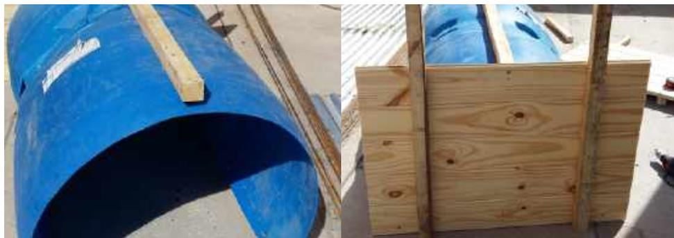
Armar las tapas de madera con una medida aproximada de 67 x 57 cm. Una de ellas deberá contar con una apertura para la entrada de los lechones de 20 cm de ancho por 30 cm de alto, aproximadamente. Es recomendable utilizar el resto de los listones de madera como anclaje para que el recuadro no se deforme.
